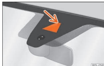
Abb. 141 Kamerasichtfenster des Spurhalteassistenten.
