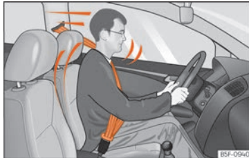
Abb. 6 Richtig angegurtete Fahrer werden bei einem plötzlichen Bremsmanöver nicht nach vorne geschleudert.
