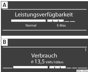
Abb. 61 Im Display des Kombi-Instruments: Leistungsverfügbarkeit. A : Vollständige Anzeige. B : Nach unten verschobene Anzeige.
