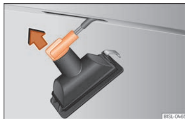
Abb. 55 Kennzeichenleuchte: Lampenträger ausbauen.
