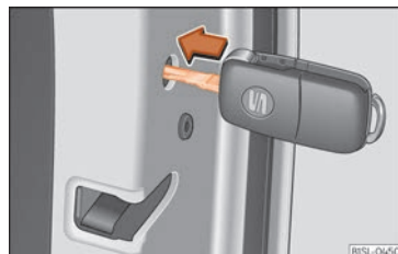
Abb. 71 Notverriegelung des Fahrzeugs mit dem Fahrzeugschlüssel.
