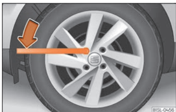
Abb. 33 Radwechsel: Radschrauben lockern
