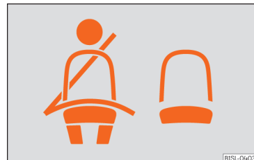
Abb. 5 Gurtstatusanzeige für die hinteren Sitzplätze im Display des Kombi-Instruments.
