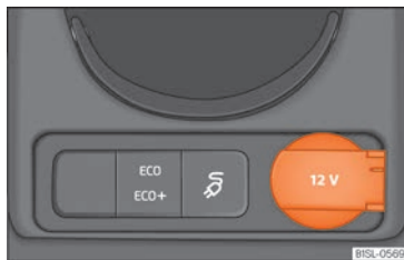
Abb. 106 Mittelkonsole vorn: 12-Volt-Steckdose im Ablagefach und USB-Schnittstelle.
