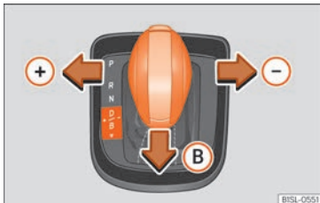
Abb. 135 Am Wählhebel: Schalten der Rekuperation.
