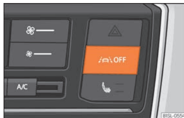
Abb. 142 In der Mittelkonsole: Taste zum Einschalten des Spurhalteassistenten
