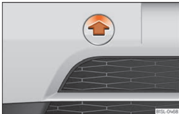
Abb. 42 Vorderer Stoßfänger, rechte Seite: Abdeckung abziehen.
