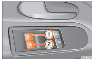
Abb. 76 Ausschnitt der Fahrertür: Tasten zum Bedienen der elektrischen Fensterheber
