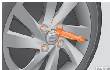
Abb. 37 Radwechsel: Radschrauben mit dem Schraubendrehergriff abschrauben.
