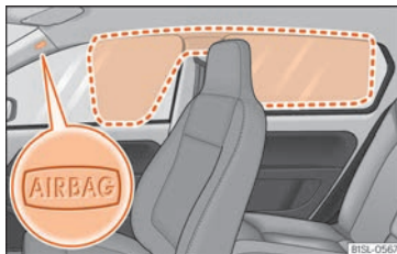
Abb. 19 Einbauort und Entfaltungsbereich des Kopfairbags.
