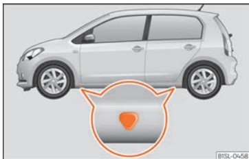
Abb. 35 Aufnahmepunkte für den Wagenheber.
