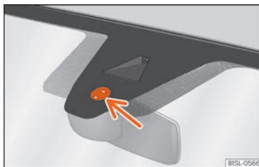
Abb. 86 Sensitive Fläche des Regensensors.
